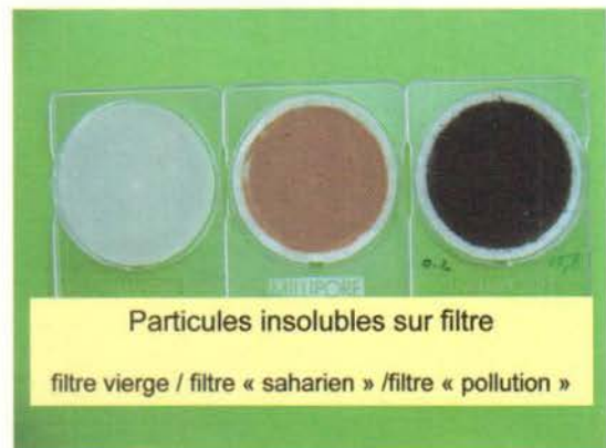
Photo 3 : Photo de la fraction insoluble des précipitations de septembre (à droite), juillet (au milieu) 2002 - Pirio Forêt - recueillie sur filtres en polycarbonate de porosité 0.4 \mu ; un filtre vierge est montré à gauche.
