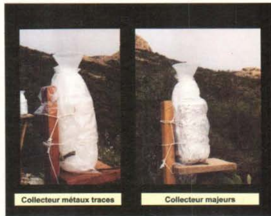
Photo 1 : Les collecteurs de dépôt total.
