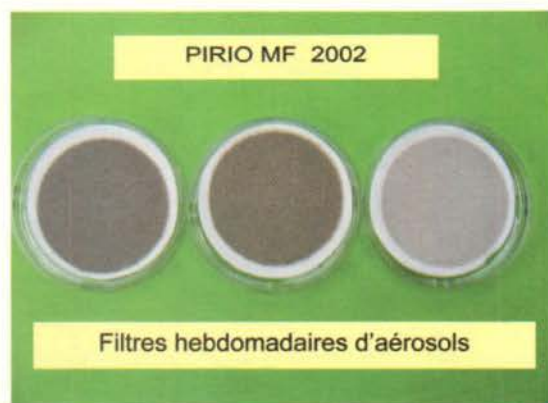
Photo 5 : Photo de filtres hebdomadaires d'aérosols collectés en 2002 à Pirio Maison Forestière (filtration d'environ 150m 3 d'air sur des filtres en téflon de porosité 0.45 \mu ).
